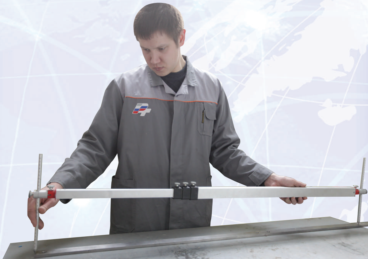
Проверка телескопической линейки, используемой для измерения контрольных точек геометрии кузова автомобиля, с помощью плоскопараллельных концевых мер длины
