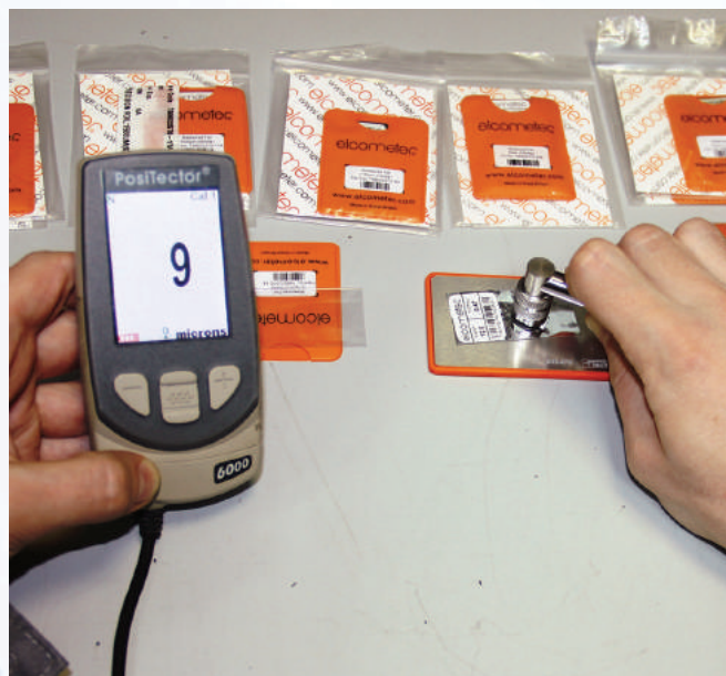
Проверка толщиномера лакокрасочного покрытия. В качестве эталона применяется комплект мер толщины
