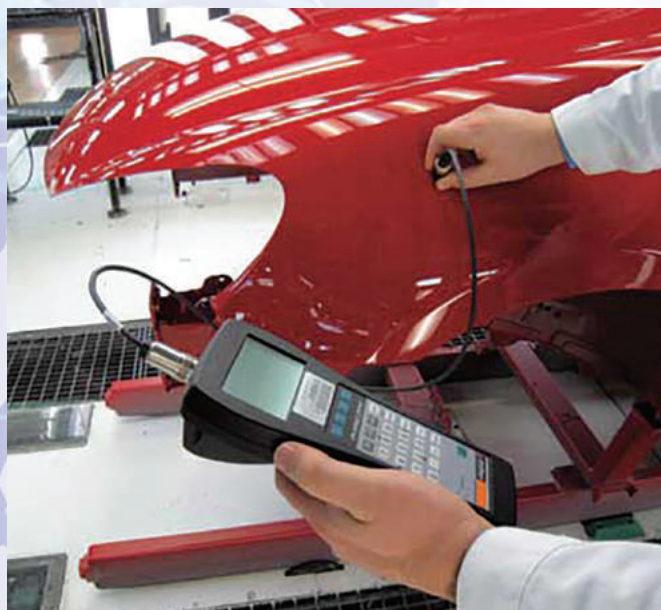
Проверка толщины лакокрасочного покрытия кузова автомобиля с помощью толщиномера
