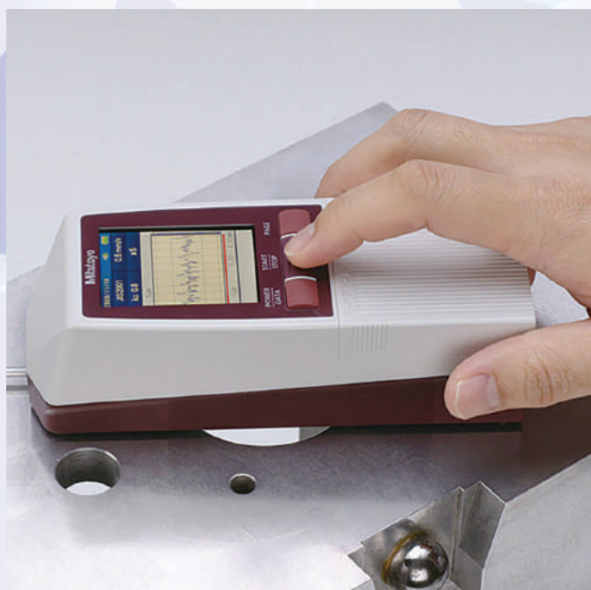
Измерение профилометром шероховатости поверхности детали автомобиля
