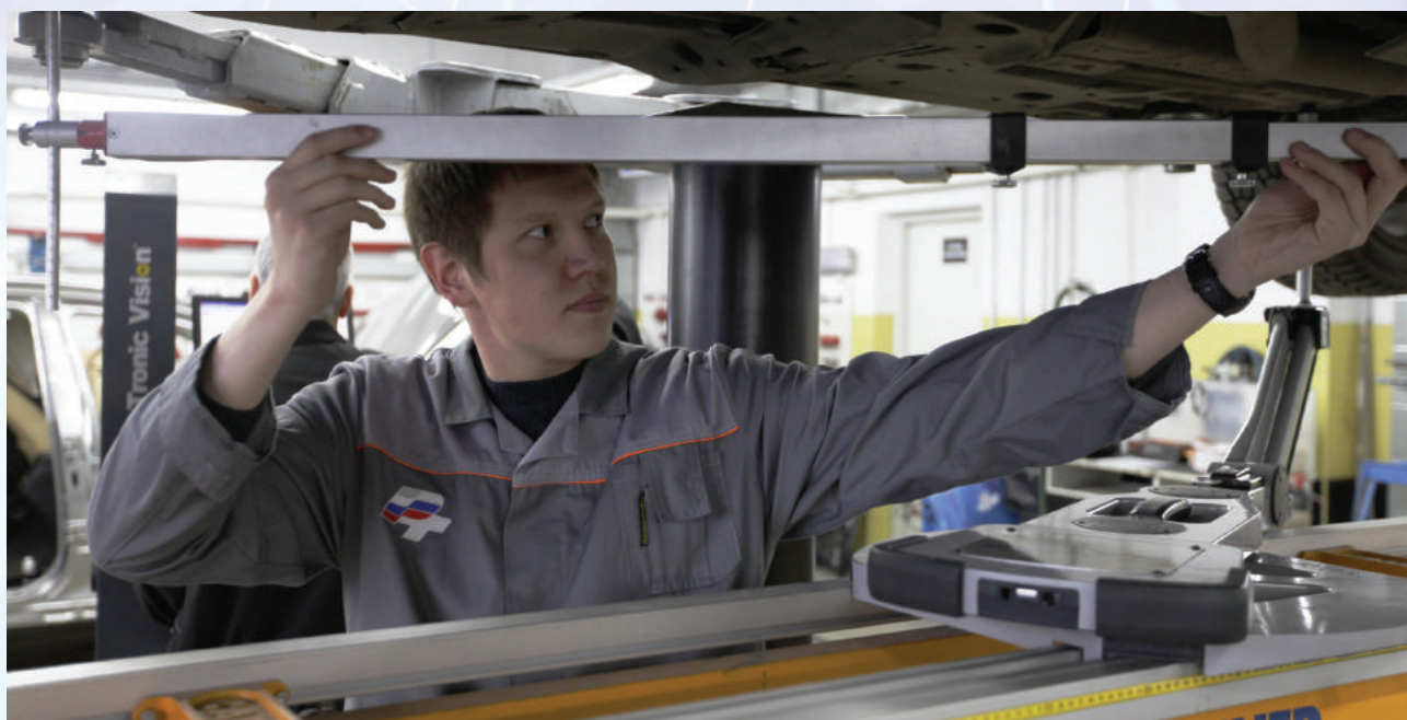
Опробование телескопической линейки
