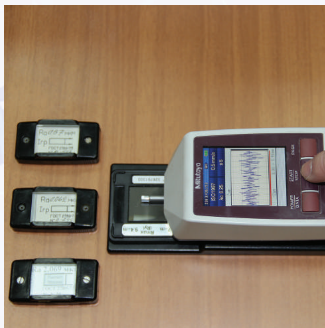
Проверка профилометра с помощью образцовых мер шероховатости
