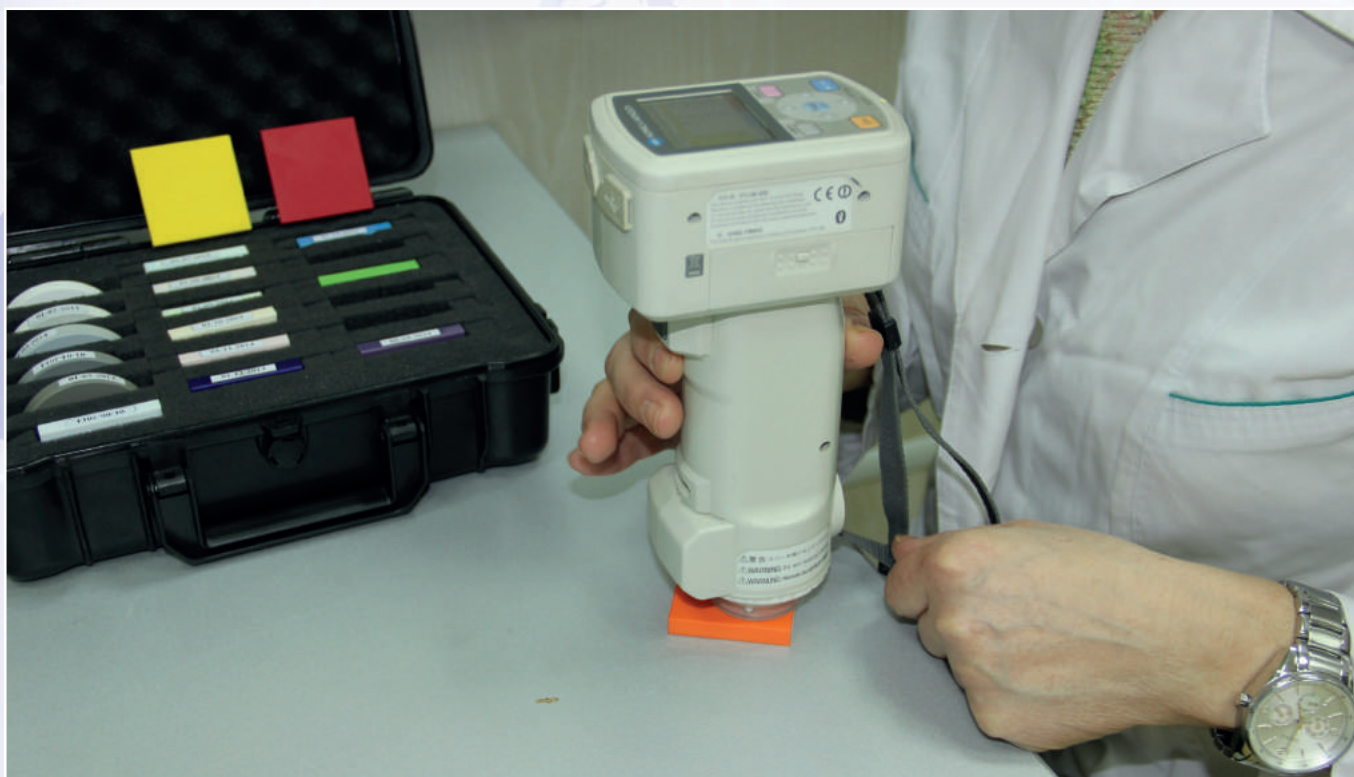
Набор мер отражающих НМОКЦЦ-1 для передачи размера единиц координат цвета и координат цветности при поверке спектроколориметров, используемых для измерения цветовых характеристик окрашенных поверхностей
