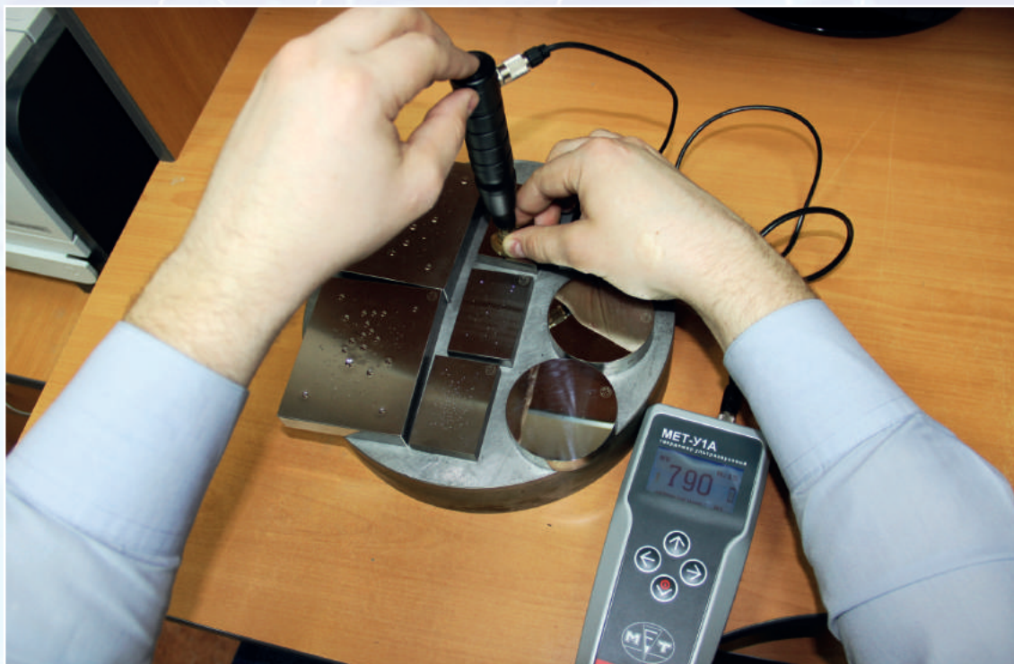
Проверка портативного твердомера. В качестве эталона применяются меры твердости 2-го разряда
