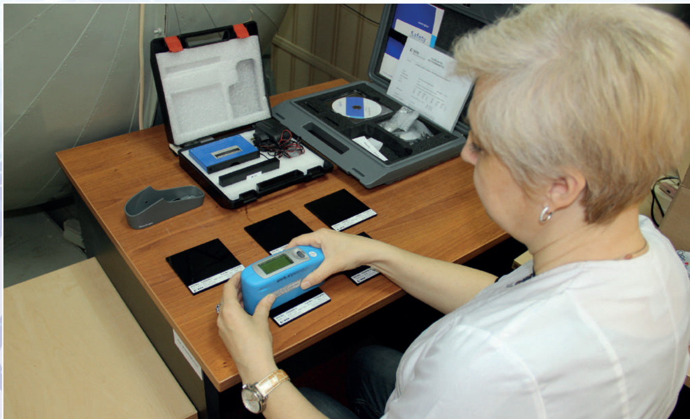
Поверка блескомеров с помощью набора эталонных мер
