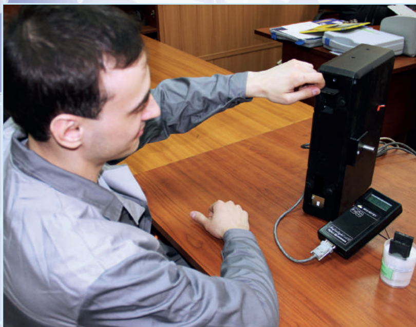
Поверка дымометров с применением эталонного комплекта светофильтров
