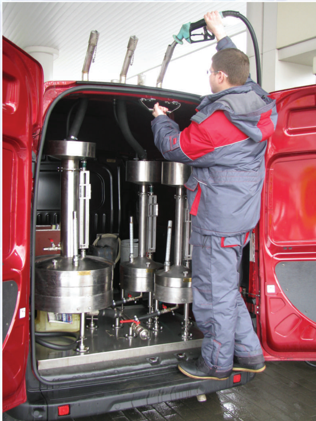
Передвижная поверочная лаборатория. Проверка топливораздаточных колонок на автозаправочной станции
