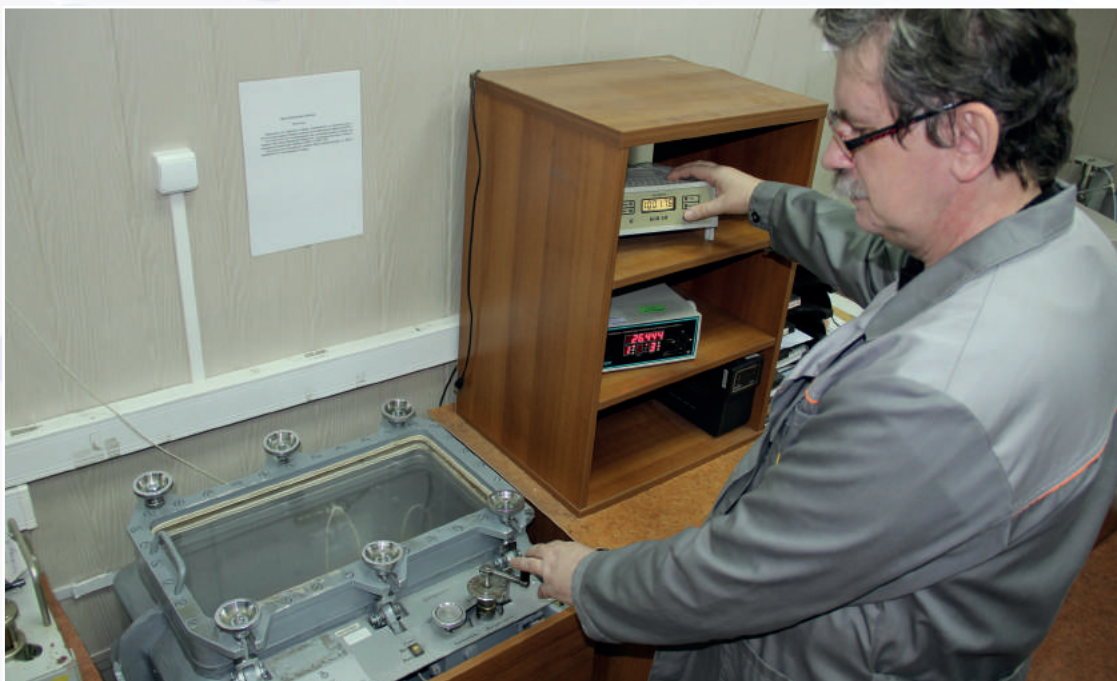
Проверка барометров anerоидных метеорологических с помощью образцового переносного барометра БОП-1М-3
