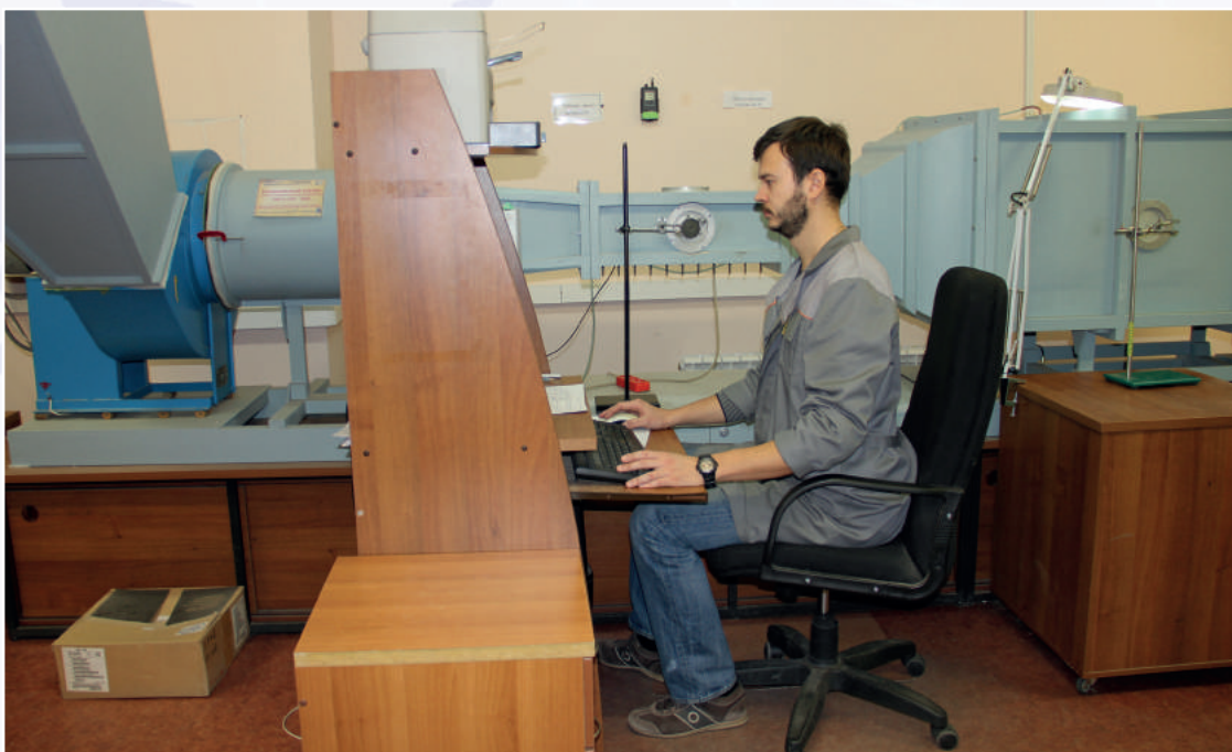
Проверка метеостанций, применяющихся в авиации и судоходстве по параметру: скорость воздушного потока
